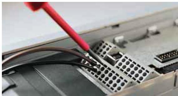
Нажать, вставить, отпустить - и надежное соединение кабеля обеспечено
