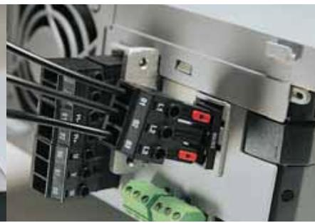
Plug – and – Play – технология «горячего» подключения широко применяется в приводах VLT® AutomationDrive. Даже кабели питания и датчиков обратной связи имеют максимально удобное подключение
