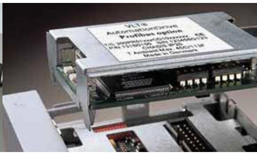
Опции связи Fieldbus подключаются в нижней части передней панели. При необходимости можно подключить кабель сверху, перевернув соответствующий элемент.
